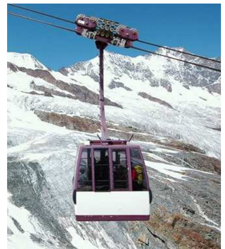
Auch diese Bahn steht für besondere Innovation: Die weltweit erste Luftseilbahn an drei Seilen schwebt seit 1991 in Saas Fee den Berg hoch. Foto Martin Arnold
